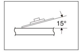
ATENÇÃO A pressão excessiva ou repentina do disco retardará a ação de esmerilhamento e colocará tensões perigosas para a estrutura do disco. Ao esmerilhar com um disco novo, certifique-se de esmerilhar enquanto puxa a ferramenta para trás até que o disco fique arredondado em sua borda. Os discos novos têm cantos afiados, que tendem a "morder" ou cortar a peça de trabalho ao ser empurrado para a frente.
